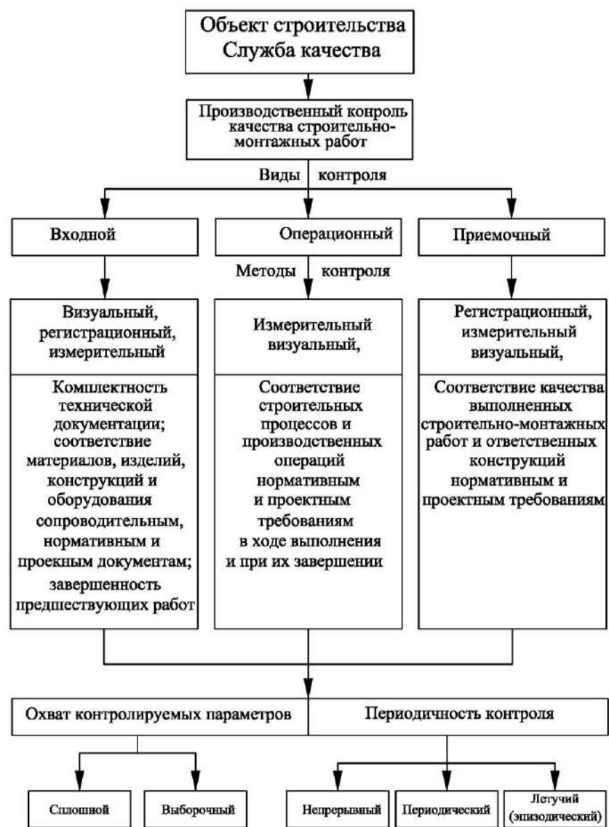
Рисунок 10.1 – Схема производственного контроля качества строительно-монтажных работ
