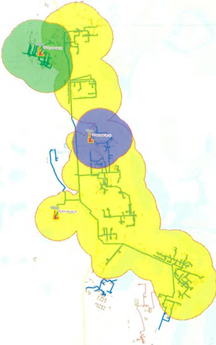
Рисунок 7. Ориентировочные зоны радиусов эффективного теплоснабжения для среднеподключаемой тепловой нагрузки к точкам сброса
