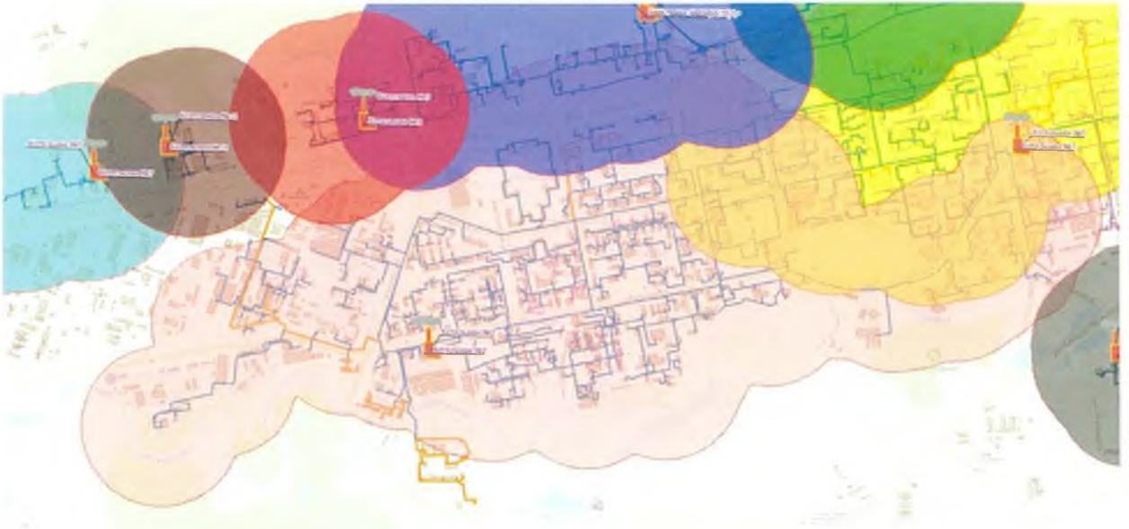
Рисунок 3. Ориентировочные зоны радиусов эффективного теплоснабжения для среднеподключаемой тепловой нагрузки к точкам сброса
