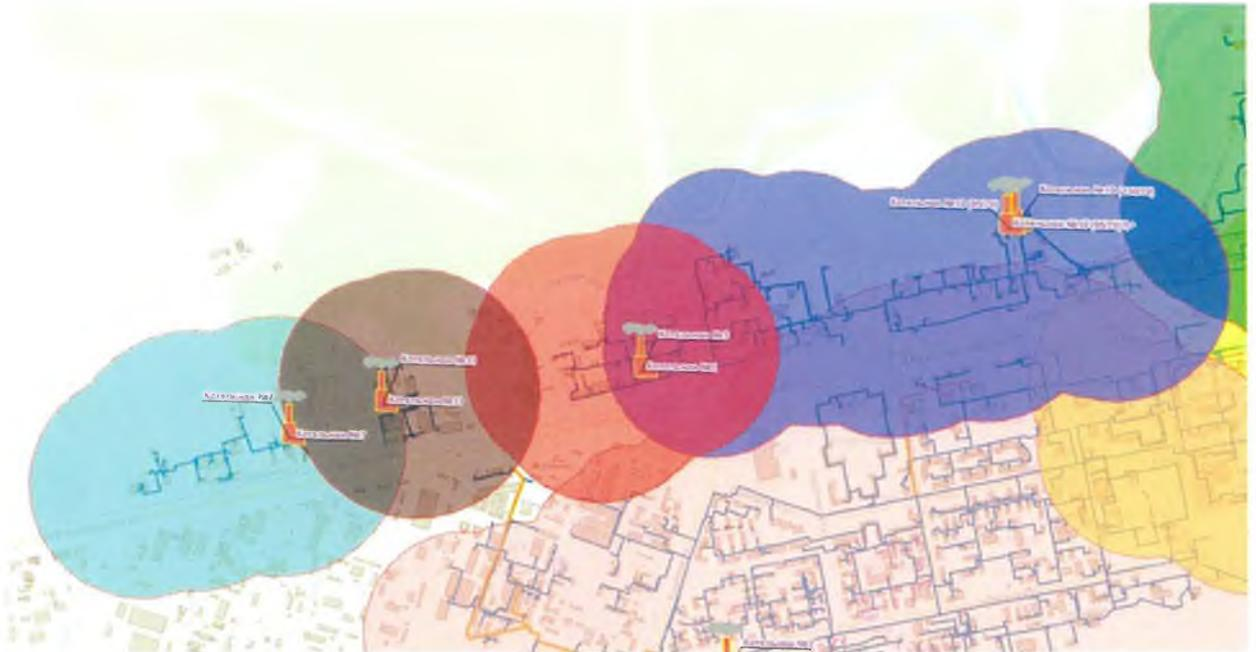
Рисунок 1. Ориентировочные зоны радиусов эффективного теплоснабжения для среднеподключаемой тепловой нагрузки к точкам сброса
