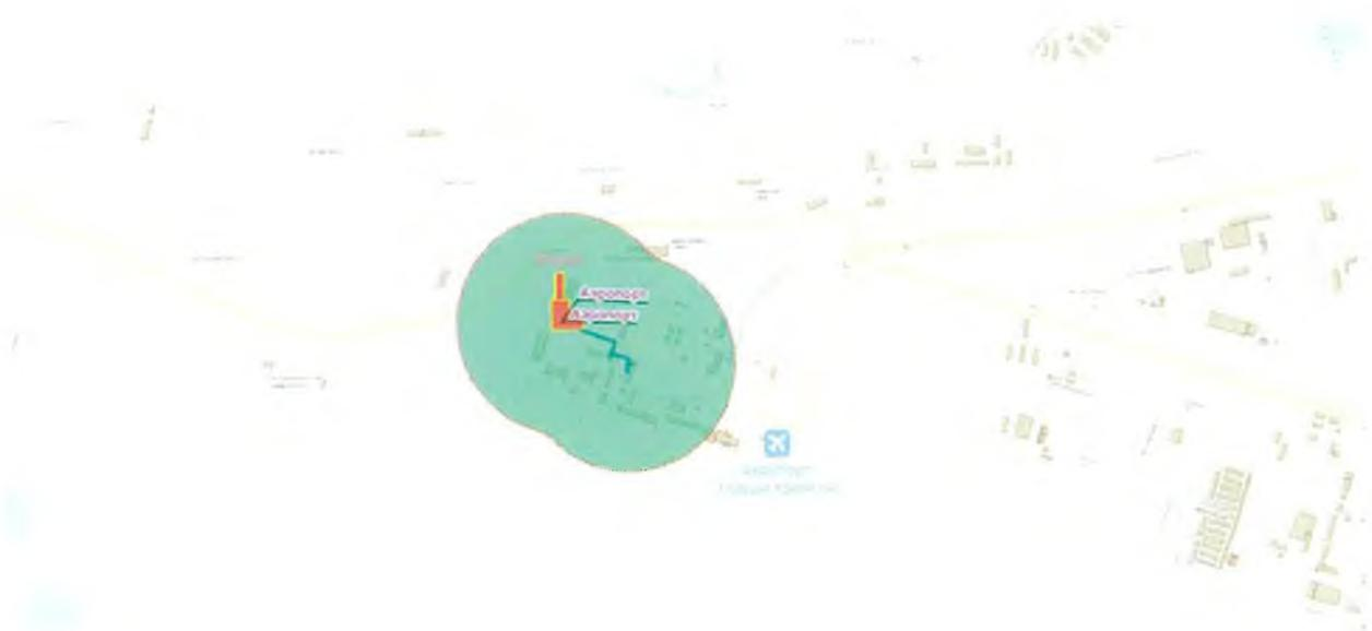
Рисунок 4. Ориентировочные зоны радиусов эффективного теплоснабжения для среднеподключаемой тепловой нагрузки к точкам сброса
